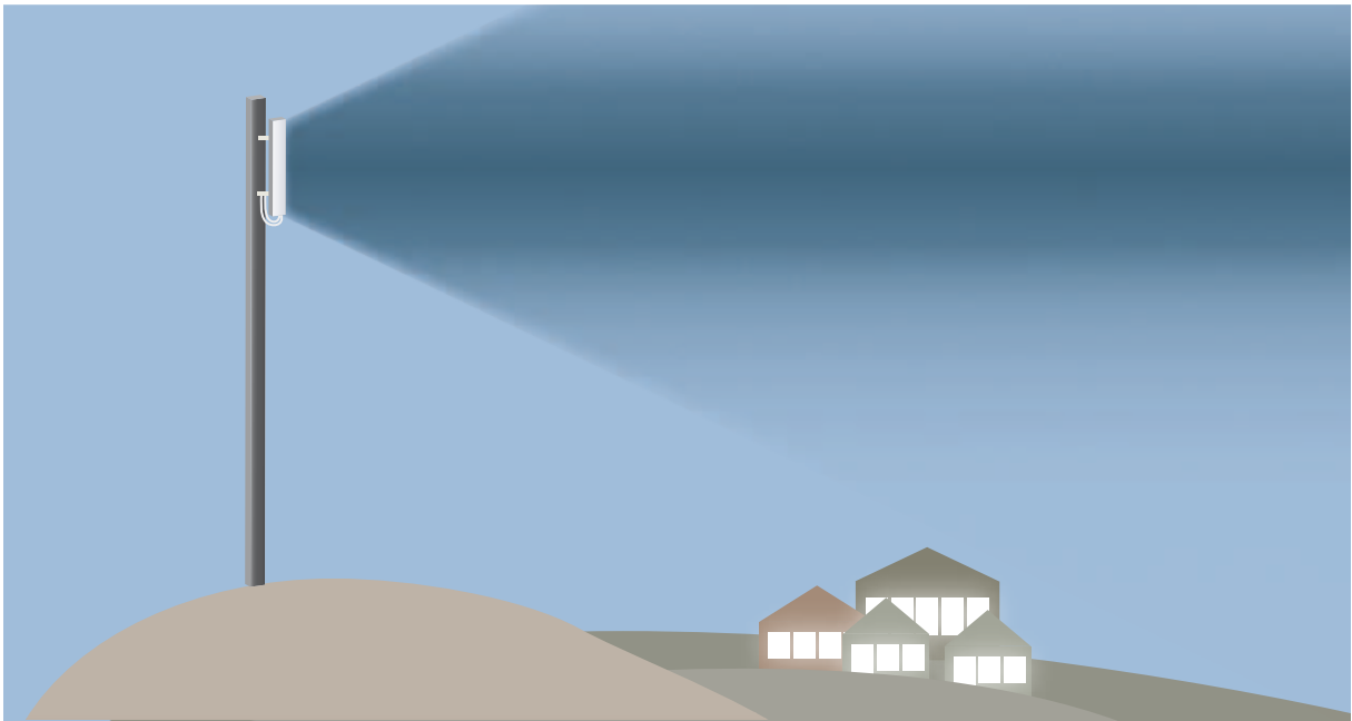
Figur 3.3. Eksempel på hvordan radiobølgene som sendes ut fra en mobilantenne fordeles seg. Kilde: Statens strålevern
